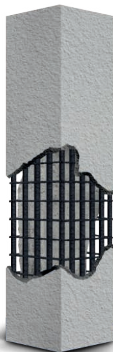
Φάση 2 Αφαίρεση του επιχρίσματος και της επικάλυψης του οπλισμού μέχρι να προκύψει υγιές σκυροδέμα
